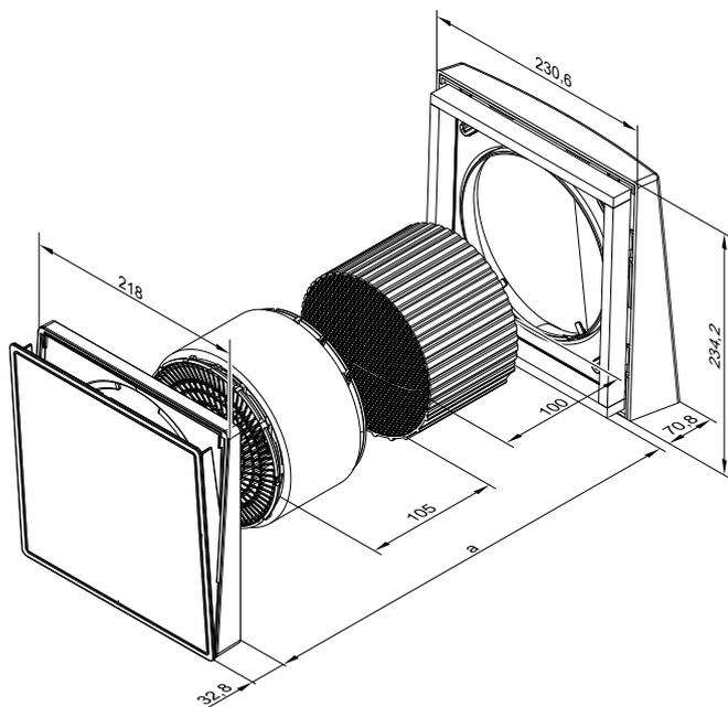
a Min./max. Wandstärke ist abhängig von der verwendeten Kombination aus Wandhülse und Außenwandblende.
