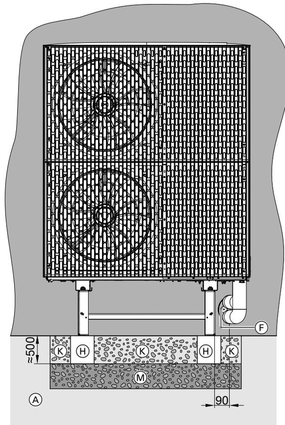
Abb. 33 Max. Wandabstand mit Design-Verkleidung (Zubehör): 300 mm
