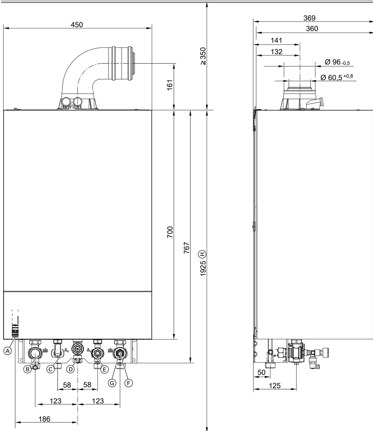
Abb. 2 Dargestellt Gas-Brennwertkombigerät
